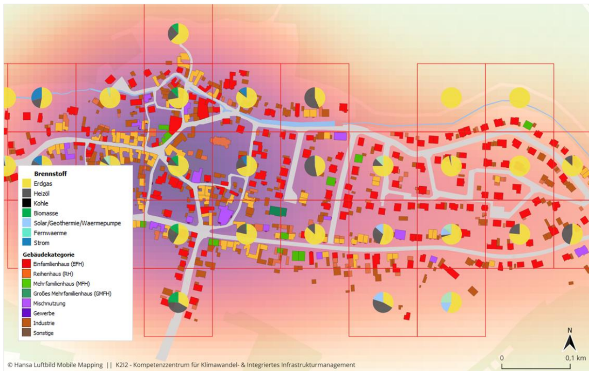
Abb. 10: Ermittelte räumliche Brennstoffverteilung, dargestellt auf dem 100x100-m-Zensusgitter
