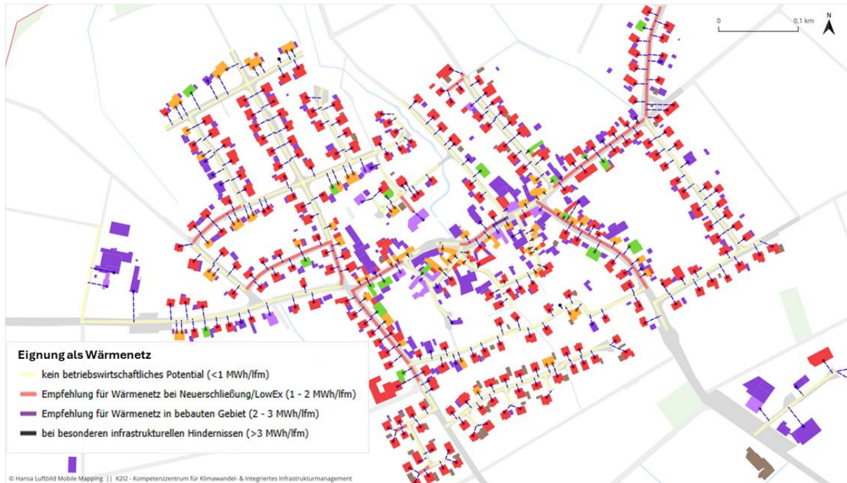
Abb. 11: Wärmelinien-dichte (MWh/m) und korrelierende geeignete Wärmenetztypen
