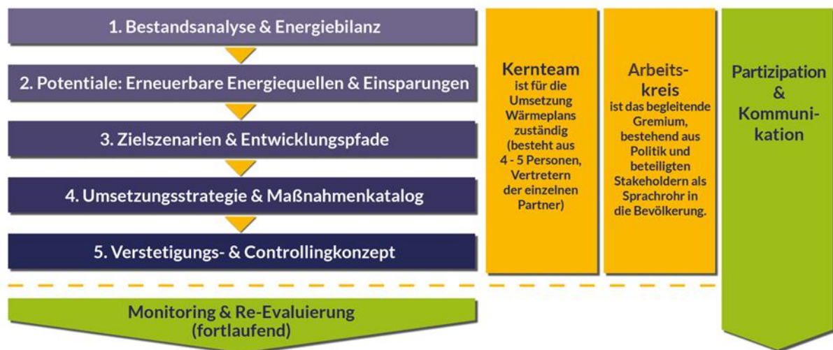
Abb. 2: Phasen & Arbeitspakete des kommunalen Wärmeplans
