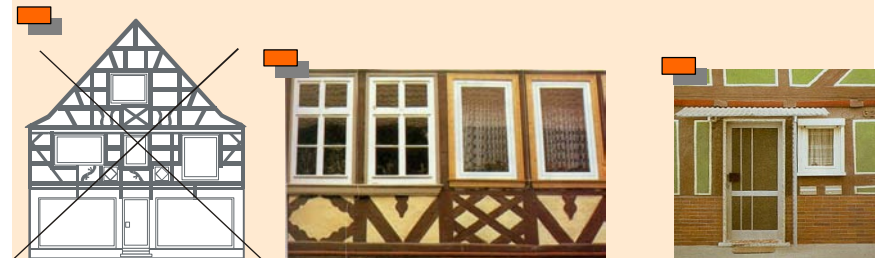
Beispiel für Fenster- und Türformate, die sich nicht in die Fassade einfügen.
