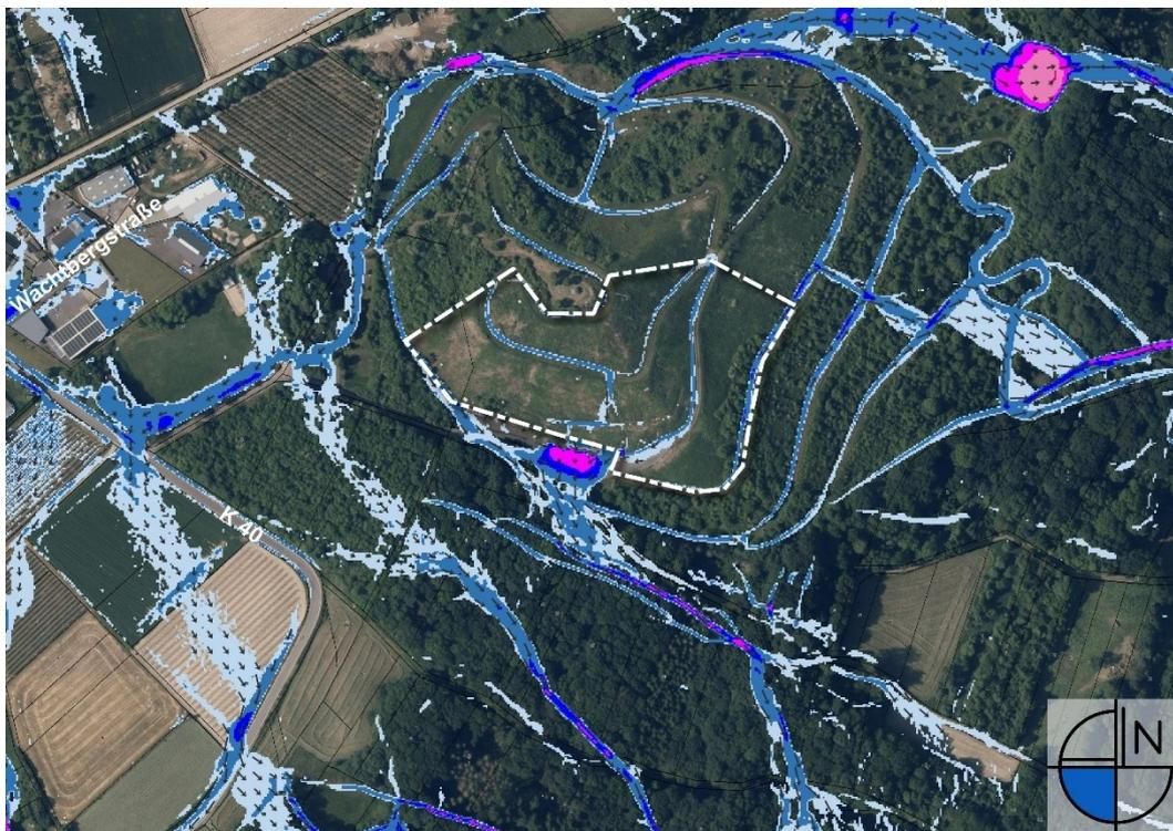
Abb.: Auszug aus der Sturzflutkarte bei einem extremen Starkregenereignis (SRI 10) mit einer Regenmenge von ca. 112 – 136 mm in 4 Stunden und Kennzeichnung des Plangebiets (= weiß), Quelle: Digitale Orthophotos: ©GeoBasis-DE / LVermGeoRP2024, dl-de/by-2-0, www.lvermgeo.rlp.de [Daten bearbeitet]; Quelle Sturzflutkarte: Landesamt für Umwelt.
